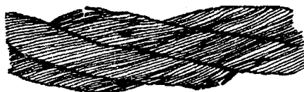
Рис. 1. Обрывы и смещения проволок каната крестовой свивки
