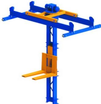
Мостовой кран-штабелер представляет собой крановый мост, по которому перемещается грузовая тележка с закрепленной на ней вертикальной колонной, как правило поворотной, по которой вертикально перемещается грузоподъемник, имеющий вилочный или специальный захват груза.
