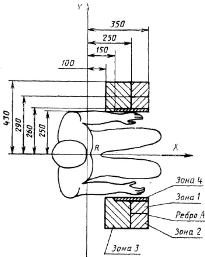
2. Центры рукоятей управления в крайнем положении контроллера и приводные элементы кнопочного управления краном должны располагаться в одной горизонтальной плоскости на расстоянии 120 мм вверх от точки  $R$ . Точку  $R$  определяют в соответствии с требованиями ГОСТ 20304.
